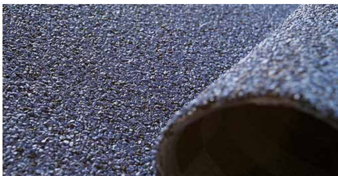
8 pav. Medžaga su stambiagrūdžiu pabarstu
